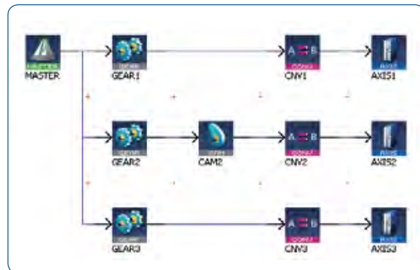
Pipe Network会通过逻辑功能块的形式显示系统的机械元件，并通过拖放操作来定位这些功能块。
