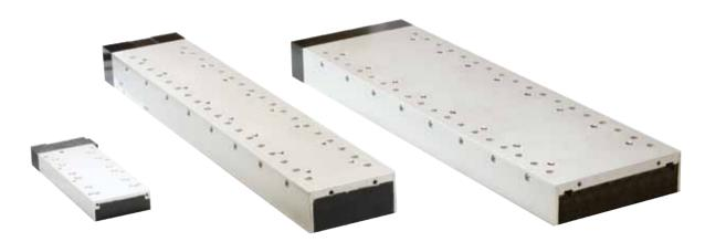
RIPPED有铁芯直线电机采用了专利化的防齿槽效应技术,能产生较大的作用力,满足很多工业应用需求,同时它又不像统铁芯直线电机那样粗糙。力的范围从13 lbf (57.8 N)的连续力到高达1671bf (7433 N)的峰值力,RIPPED系列广泛适合于有高标准需求的应用系统。
