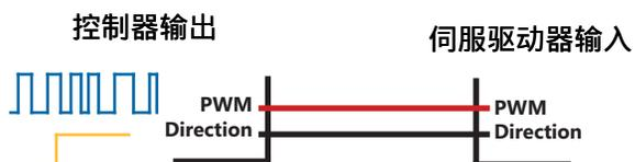
» 直接 PWM - PWM 和方向信号直接转换到输出，提供直接控制的输出占空比和开关频率。直接 PWM 是我们所有产品最快的响应，因为没有增益级或积分器。
